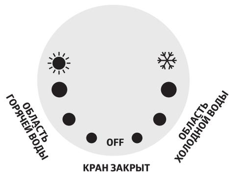
При повороте ручки в область горячей воды, включается индикатор на дисплее и вода начинает нагреваться. При повороте ручки в область холодной воды, индикатор нагрева выключается, нагрев воды прекращается, течет холодная вода, при этом кран не потребляет электроэнергию. Среднее положение ручки – кран закрыт. У модели EP-3 поверните переключатель 7 по часовой стрелке, чтобы вода выходила из душевой лейки, поверните переключатель 7 против часовой стрелки, чтобы вода выходила из излива крана.
