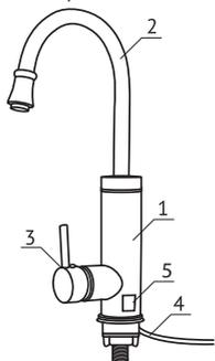
Нагрев холодной воды происходит с помощью электронагревательного элемента, расположенного внутри корпуса. В нагревательную камеру встроен датчик давления, который отключит электропитание ТЭНа при минимальном давлении 0,4 бар в системе холодного водоснабжения. Водонагреватель не перейдет в режим нагрева, если в системе холодного водоснабжения нет воды, или давление слишком мало.
